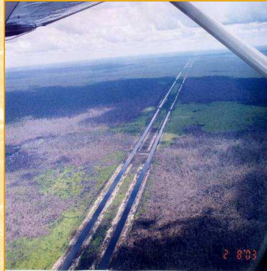
Kalimantan Mega-Rice Projekt: 1,2 Mio ha ohne Reis, 4600 km Kanäle; Hauptgraben 30 m breit, 10 m tief
